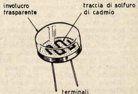
Fig. 6 - La fotoresistenza è costituita da un piccolo disco di materiale isolante sul quale è depositato un impasto di grafite e solfuro di cadmio; la sostanza conduttrice è depositata sul disco di base in forma di pista.
